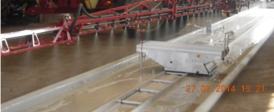
Billede 1. Måling af dysernes ydelse med sprayscanner. Foto: Hans Thostrup.
