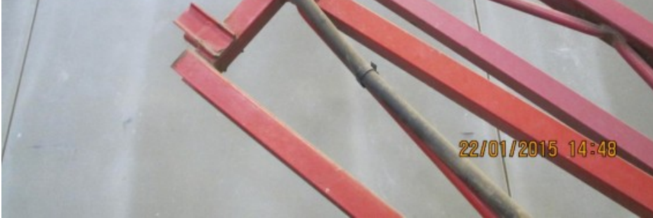
Billede 5. Undgå at slanger fanges ved sammenklapning af bom. Foto: Hans Thostrup.
