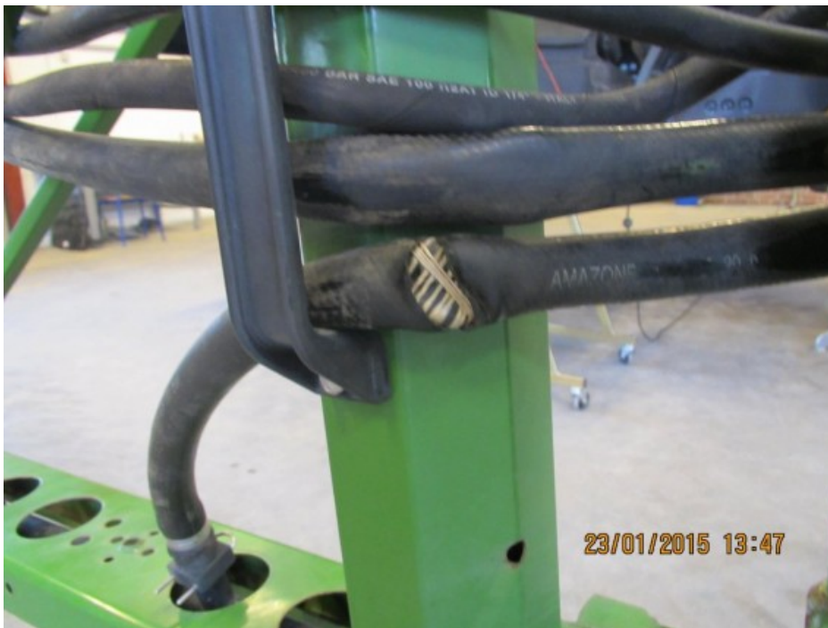
Billede 4. Slange med kraftig slitage. Kan ikke godkendes. Foto: Hans Thostrup.
