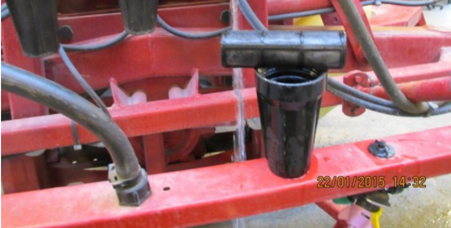
Billede 7. Beskiddt linjefilter. Rens filtre før syn. Foto: Hans Thostrup.
