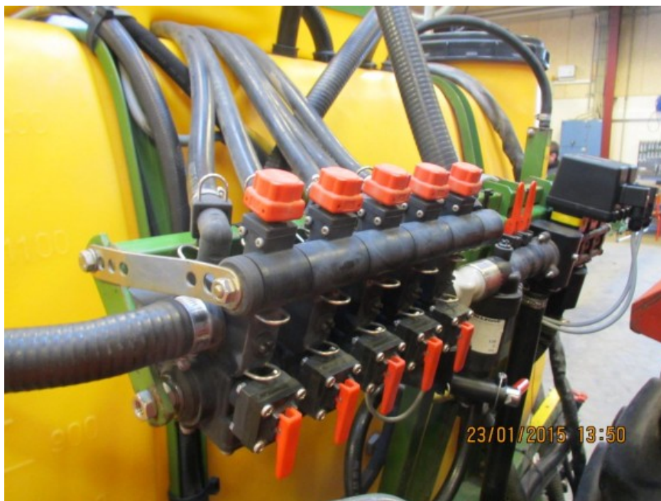
Billede 3. Armatur til regulering af sektioner. Kontroller at sektionernes ydelse er ens, når en sektion slås fra. Foto: Hans Thostrup.
